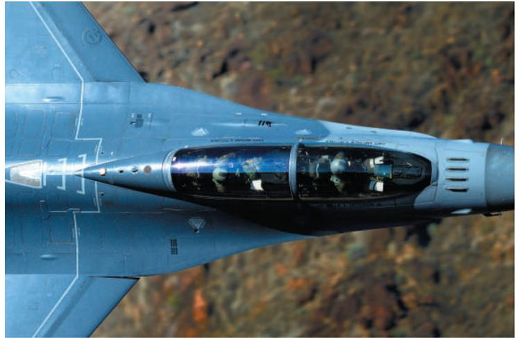
大視野的座艙頂蓋是4代機中的頂級設備。圖為雙座F-16D Block 40。可清楚地看到飛行員握著側桿操縱桿的姿勢。
