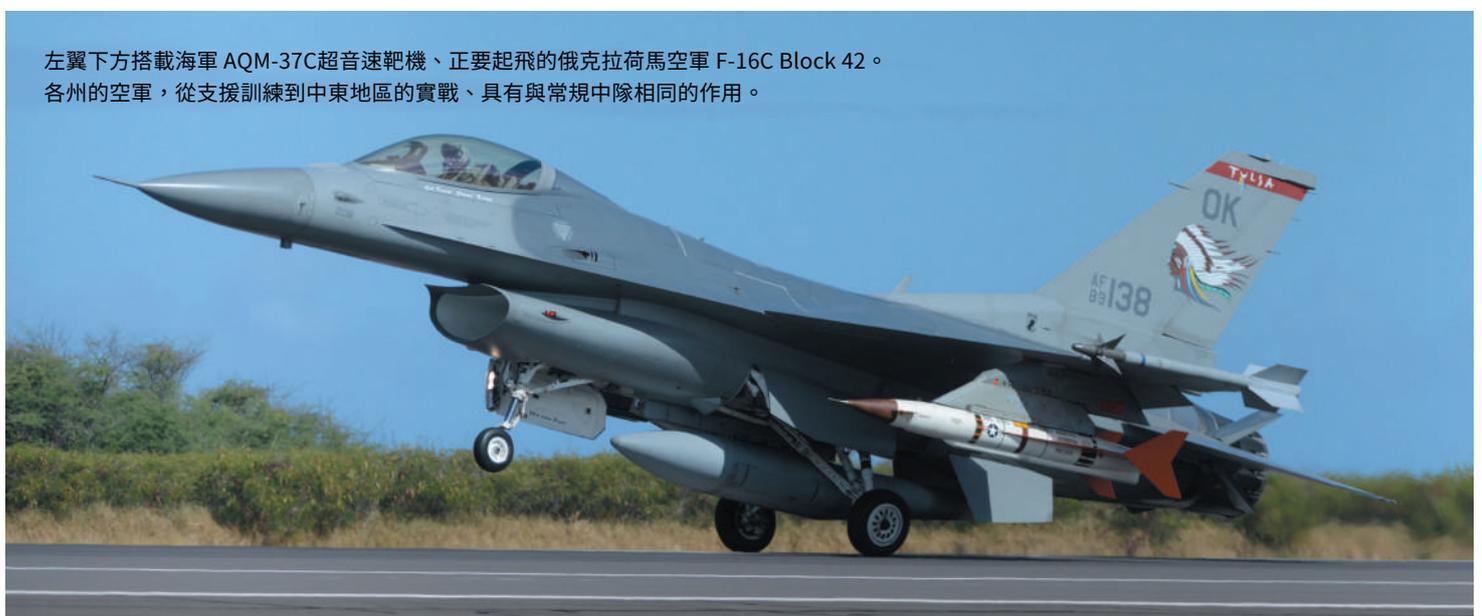
左翼下方搭載海軍 AQM-37C 超音速靶機、正要起飛的俄克拉荷馬空軍 F-16C Block 42。各州的空軍，從支援訓練到中東地區的實戰、具有與常規中隊相同的作用。
