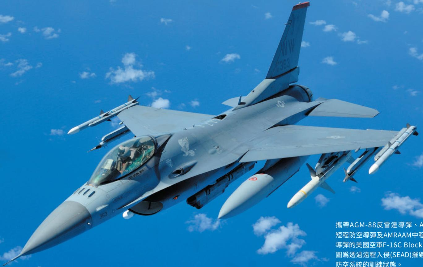
攜帶AGM-88反雷達導彈、AIM-9短程防空導彈及AMRAAM中程防空導彈的美國空軍F-16C Block 50。圖為透過遠程入侵(SEAD)摧毀敵方防空系統的訓練狀態。
